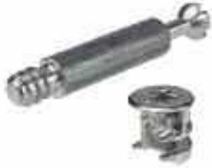
El sistema de herrajes de unión para armarios Minifix se basa en el principio de bola concéntrica. Este diseño permite integrar una gran superficie de tracción y apoyo en la pequeña caja del herraje, lo cual garantiza una unión sólida e indeformable. El perno de cabeza semicircular se introduce en el centro del hueco esférico de la carcasa del herraje Minifix, y después se ajusta para estabilizar la unión.
